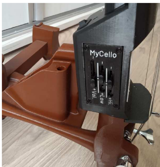
Obrázek 2.3 Potenciometry pro regulaci hlasitosti, basů a výšek
