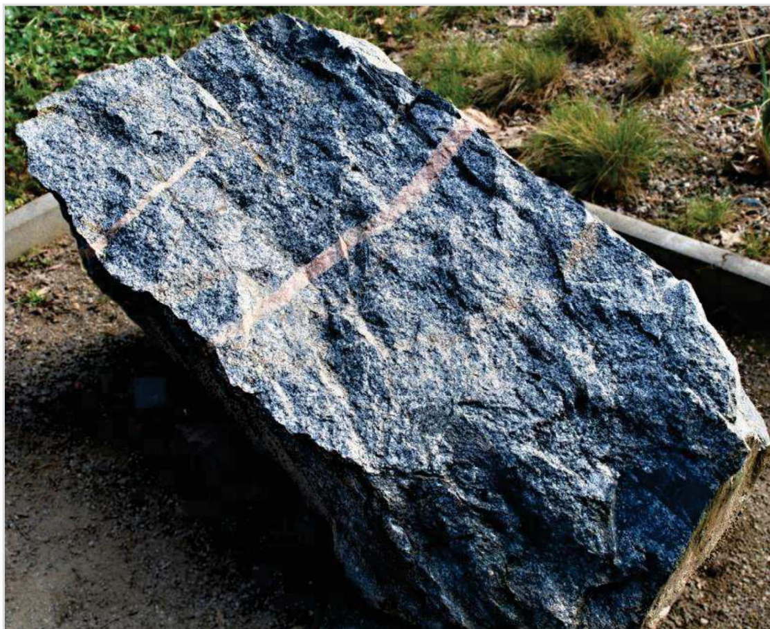
Obr. 2.8 Biotitický granodiorit z oblasti Dolní Kounice [1];
