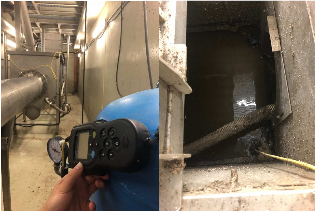
Obrázek 4.4 Měření ORP na vtoku na ČS
