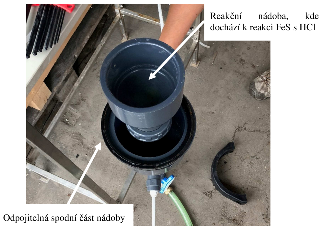
Obrázek 3.1 Reakční nádoba spodní odnímatelná část
