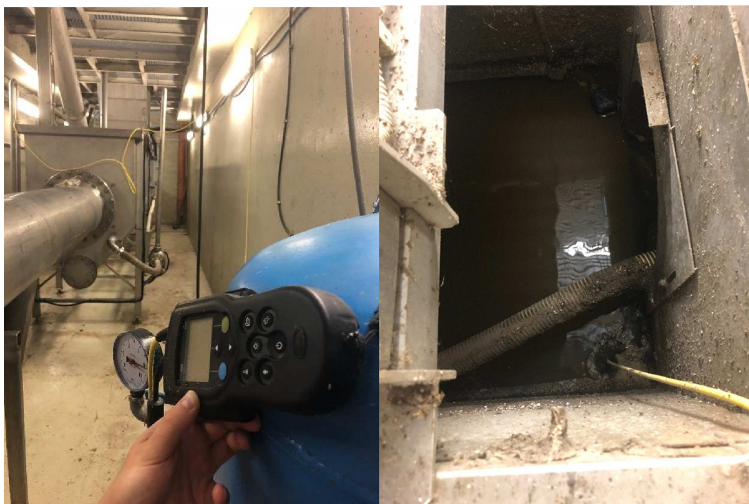
Obrázek 4.4 Měření ORP na vtoku na ČS
