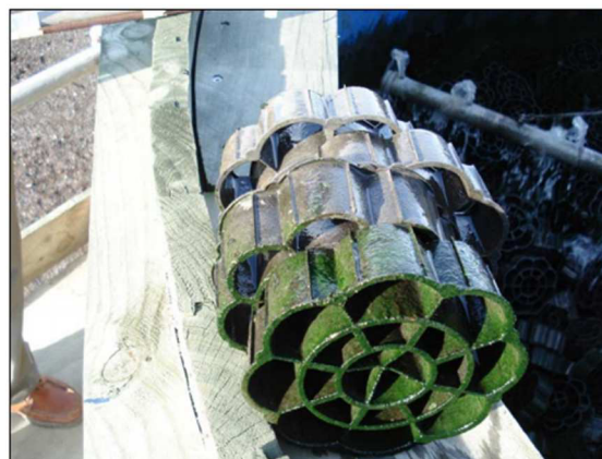
Obrázek 2.11 Schéma biologické pračky vzdušiny a příklad náplně pokryté biofilmem [34, 35]
