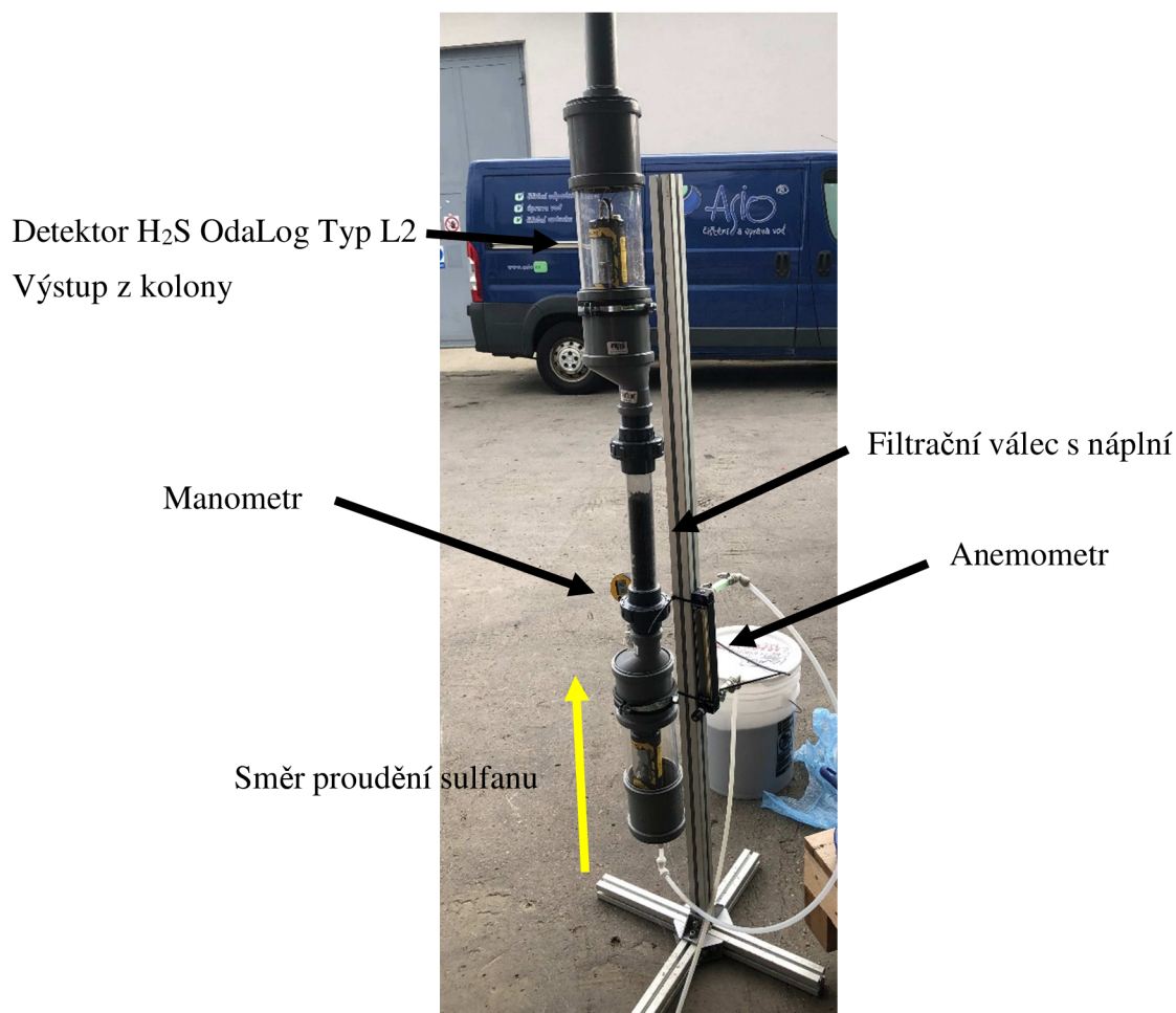
Obrázek 3.2 Umístění válce s filtrační náplní a OdaLogů Typ L2
