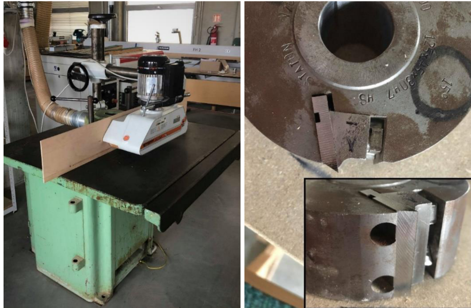
Obrázek 17: Spodní jedno-vřetenová frézka Tuttlingen vybavena přestavitelným univerzálním stojanem a podávacím zařízením STEFF 2034 (Autor, 2022)
