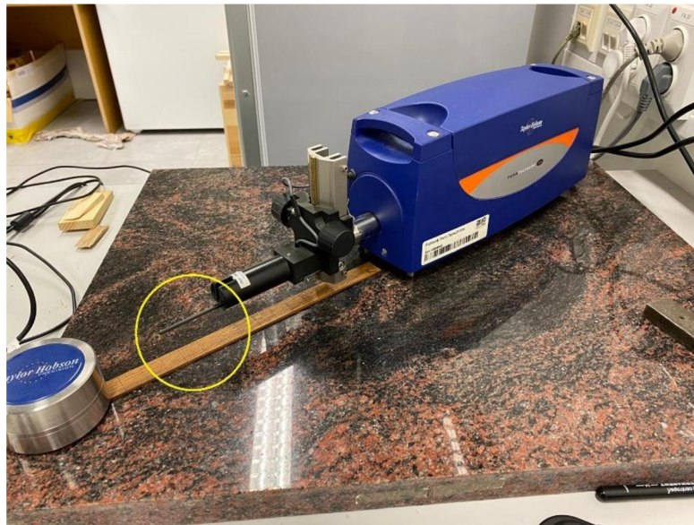
Obrázek 20: Kontaktní profilometr vybavený o raménko kontaktního profilometru s kuželovým diamantovým hrotem (Autor, 2022)
