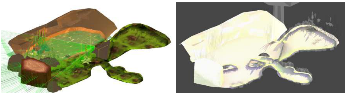
Obrázek 5.8: Na prvním obrázku je ukázka frustum culling společně s occlusion culling, kdy se vykreslují pouze objekty, které nejsou schované za ostatními objekty a jsou v zorném poli kamery. Na druhém obrázku je vytvořená světelná mapa, která ušetří výpočet světla a stínů při běhu aplikace.
