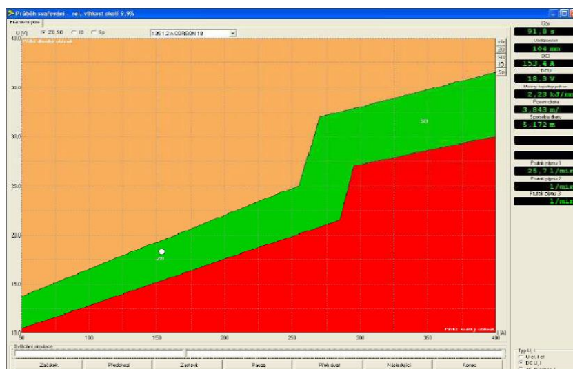
Obr. 15: Okno pracovního pole s pracovním bodem v systému WeldMonitor [3]
