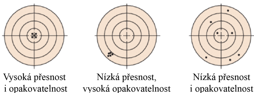
Obrázek 1.1: Přesnost a opakovatelnost pohybu. Převzato a upraveno z [9].
