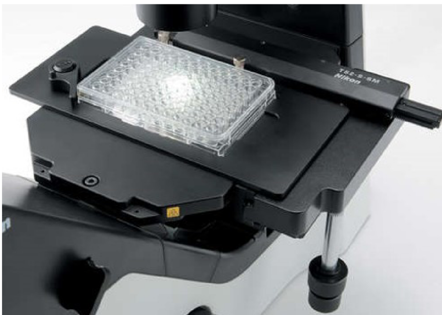
Obrázek 1.3: Manuální stolek invertovaného mikroskopu, uzpůsobený na velikost mikrotitrační destičky. Převzato z [12].
