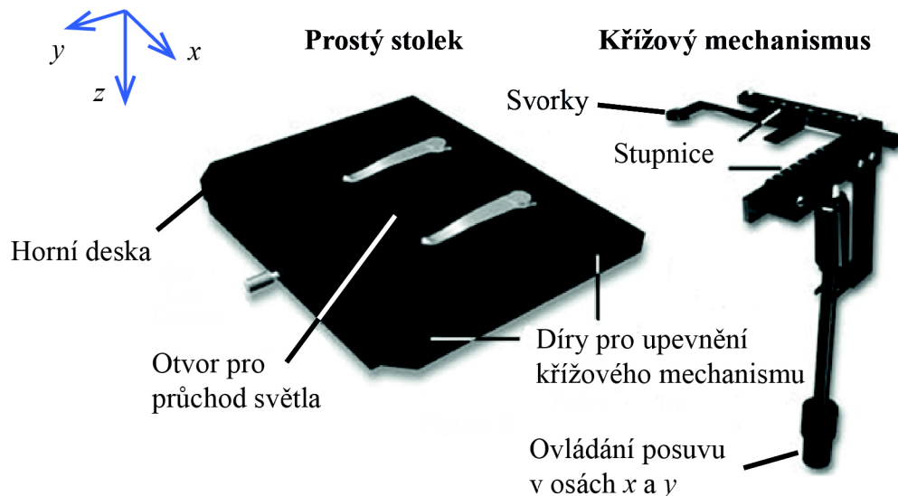
Obrázek 1.2: Prostý mikroskopový stolek s křížovým mechanismem. Převzato a upraveno z [11].
