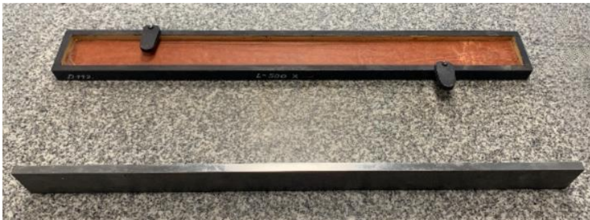
Obr. 35 Kontrolné pravítko 500 mm (identifikačné číslo D107) na ÚVSSR
