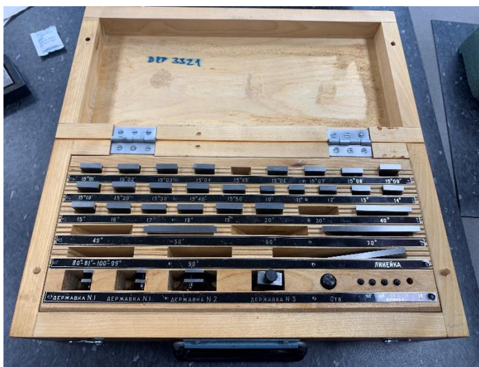
Obr. 33 Súbor uhlových mierok (výrobca ČIZ, identifikačné číslo X127) na ÚVSSR
