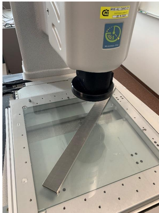
Obr. 43 Umiestnenie pravítka počas merania v rovine XY
