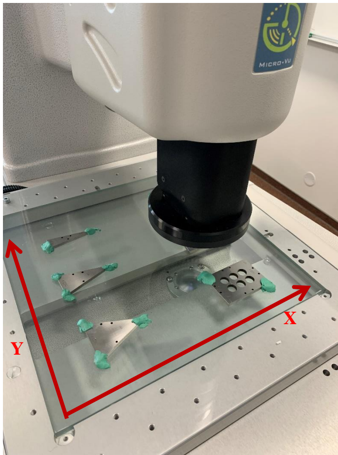
Obr. 40 Rozmiestnenie uhlových mierok počas merania v rovine XY stroja
