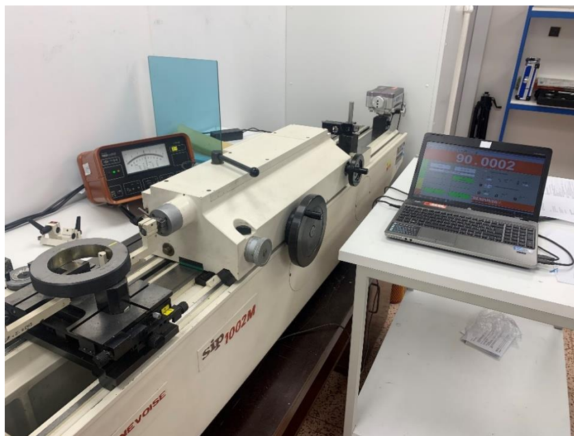
Obr. 38 Dĺžkomer SIP 1002M v spojení s laserinterferometrom XL8
