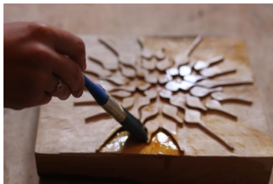
Obrázek 19 – Nanášení politury na formu
