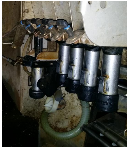
Př. 4 Strukové násadce DeLaval VMS (Tesař, 2016 (archiv autora))
