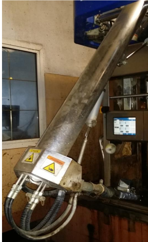
Př. 3 Robotické rameno DeLaval VMS (Tesař, 2016 (archiv autora))
