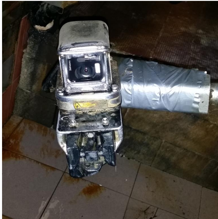
Př. 1 Optická kamera s dvěma lasery DeLaval VMS (Tesař, 2016 (archiv autora))
