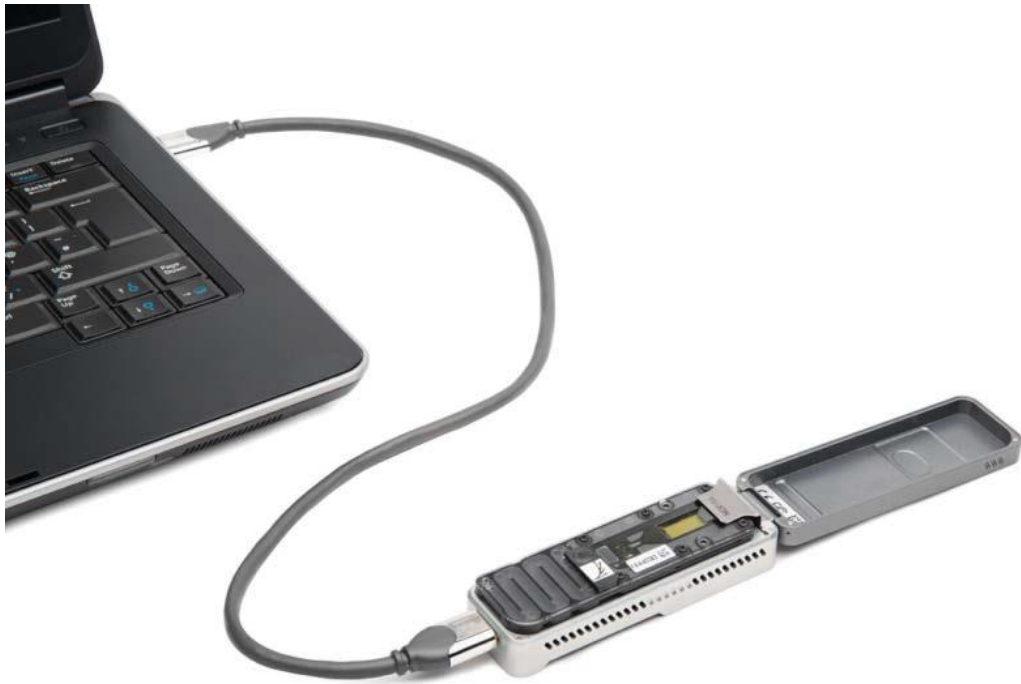
Obr. 8.: MinION zariadenie pripojené do notebooku. ( https://nanoporetech.com )
