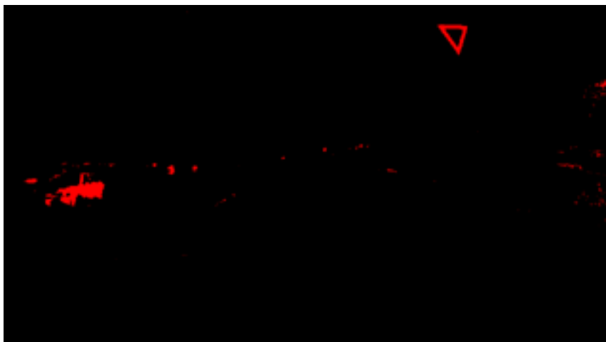
Obrázek C.10: Ukázka lokalizace červené barvy pomocí prahování v HSV
