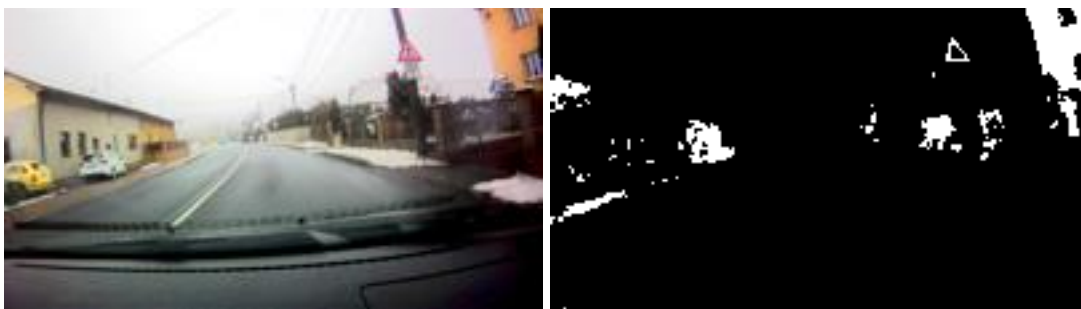
Obrázek 4.9: Ukázka barevné lokalizace pomocí prahování v HSV. Vlevo obrázek po předzpracování, vpravo binární obraz lokalit určených jako červené
