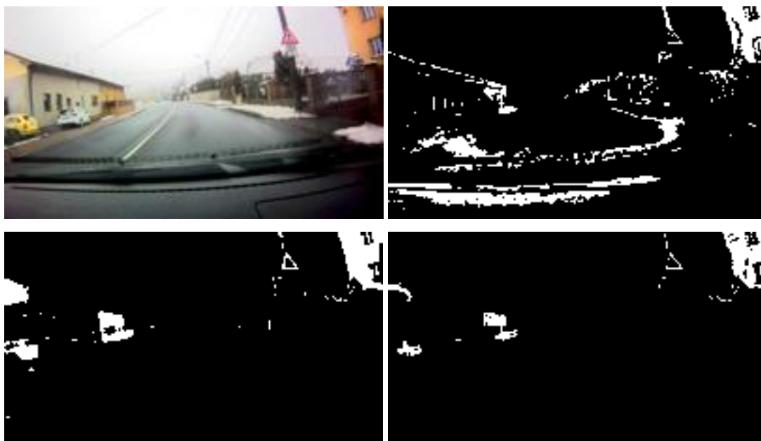
Obrázek 4.14: Ukázka barevné lokalizace pomocí RCE neuronové sítě. Vlevo nahoře obrázek po předzpracování, vpravo nahoře binární obraz lokalit určených jako červené v RGB prostoru, vlevo dole v HSV prostoru a vpravo dole v HSL prostoru
