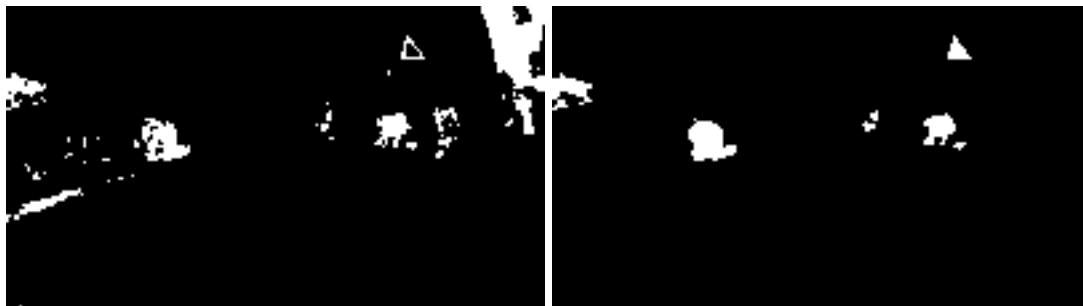
Obrázek 4.15: Ukázka redukce počtu nalezených oblastí. Vlevo binární obraz po barevné lokalizaci v HSV prostoru, vpravo obraz po redukci se zapnutým filtrováním protáhlých objektů a uzavíráním. Minimální velikost 2% výšky snímku a maximální velikost 100% výšky snímku.
