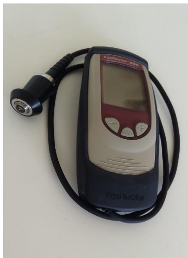
Obr. 6: Příklad na měření tloušťky filmu PosiTector 200
