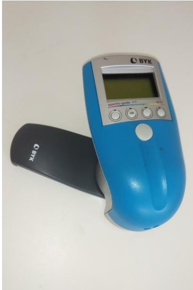
Obr. 3: Spektrofotometr BYK GARDENER používaný pro měření změny barevného odstínu a lesku
