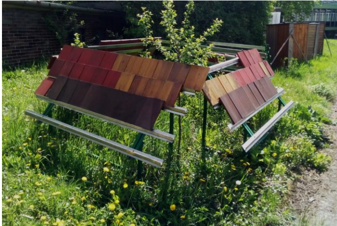
Obr. 8: Stojany pro venkovní expozici orientovány na jednotlivé světové strany
