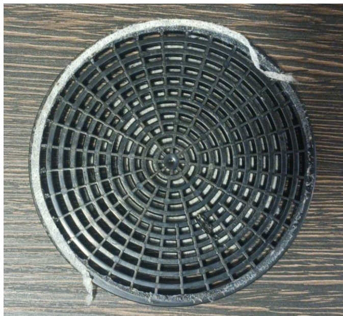
Obrázek 4 - mřížka svařená s textilií nástrojem s mezikružím
