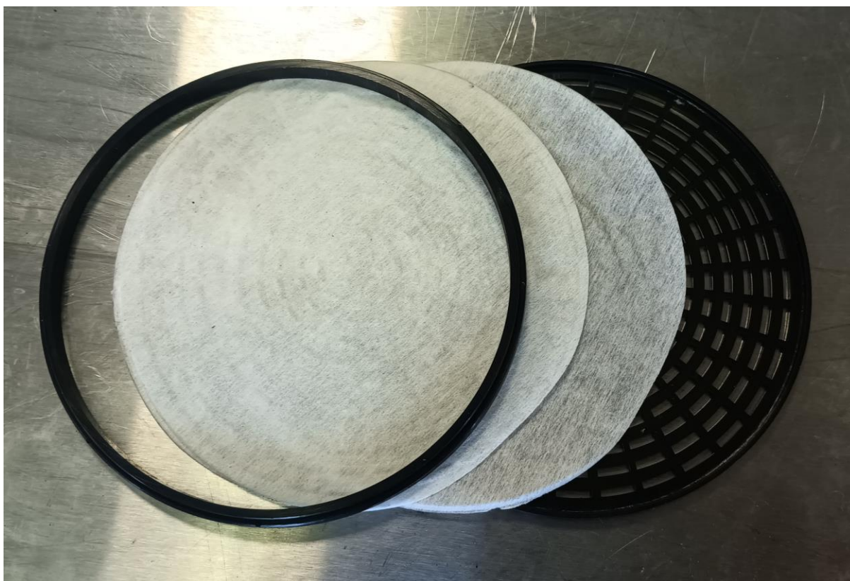
Obrázek 1 - stávající sestava spodní mřížky filtru, zprava mřížka, dvě kolečka pervinu a horní kroužek
