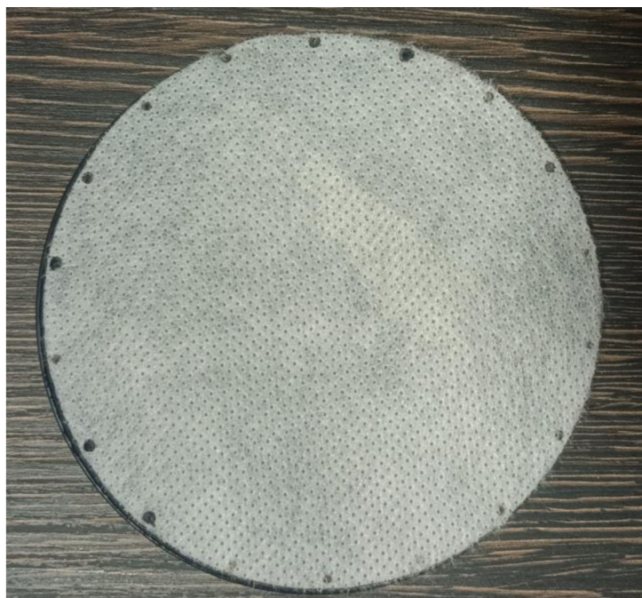
Obrázek 7 - mřížka svařená strojem, s nesouosým nástrojem během testování.
