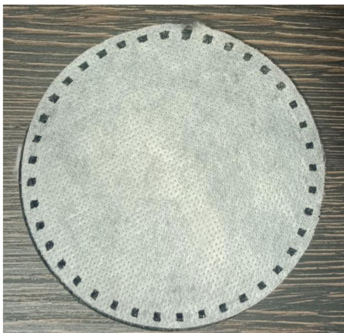
Obrázek 5 - mřížka svařená s textilií nástrojem s mezikružím s předěly
