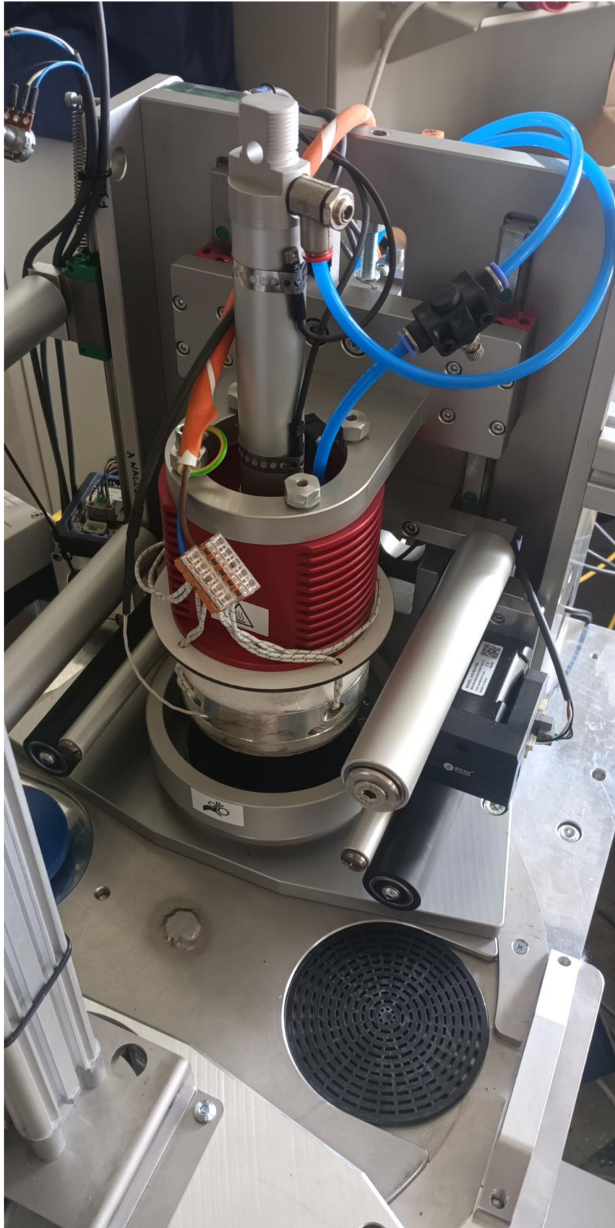
Obrázek 10 - Horní pracovní pozice, sestava horkého nástroje a neosazený otáčeč mřížky
