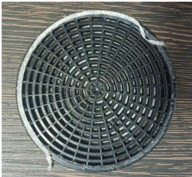
Obrázek 4 - mřížka svařená s textilií nástrojem s mezikružím
