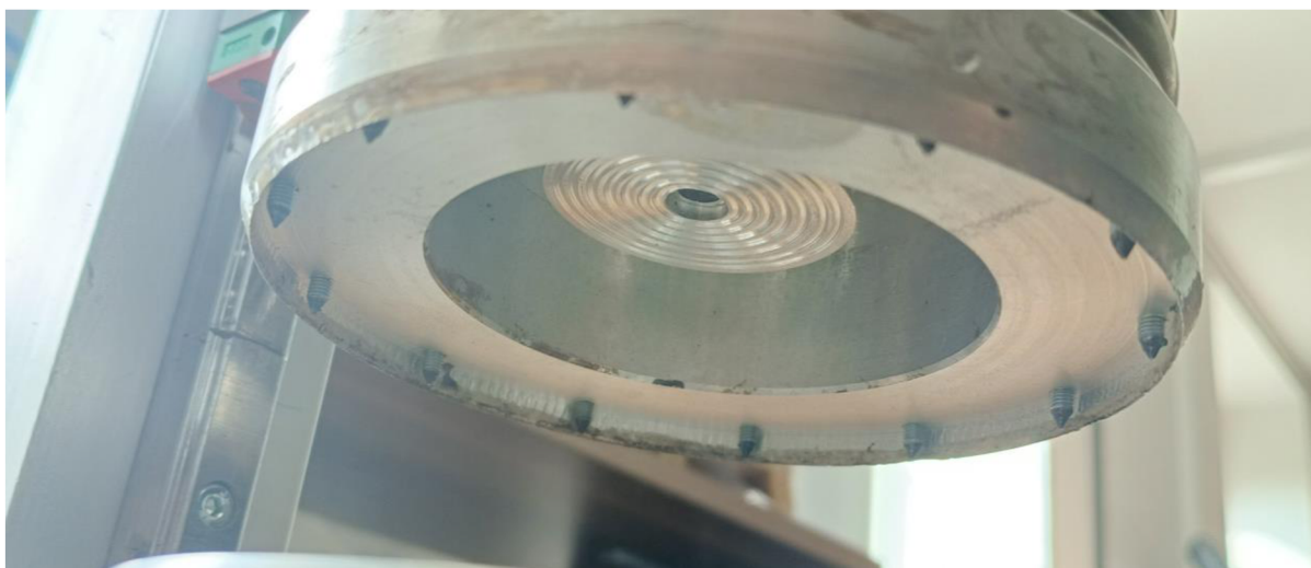
Obrázek 2 - Řezný nástroj na testovacím přípravku
