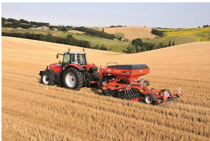
Obr. 16 - Přímé setí do nezpracované půdy
