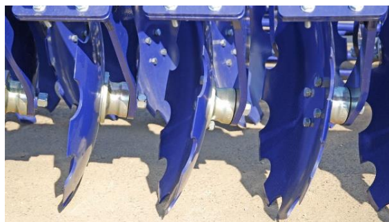
Obr. 3 - Konstrukční řešení talířů
