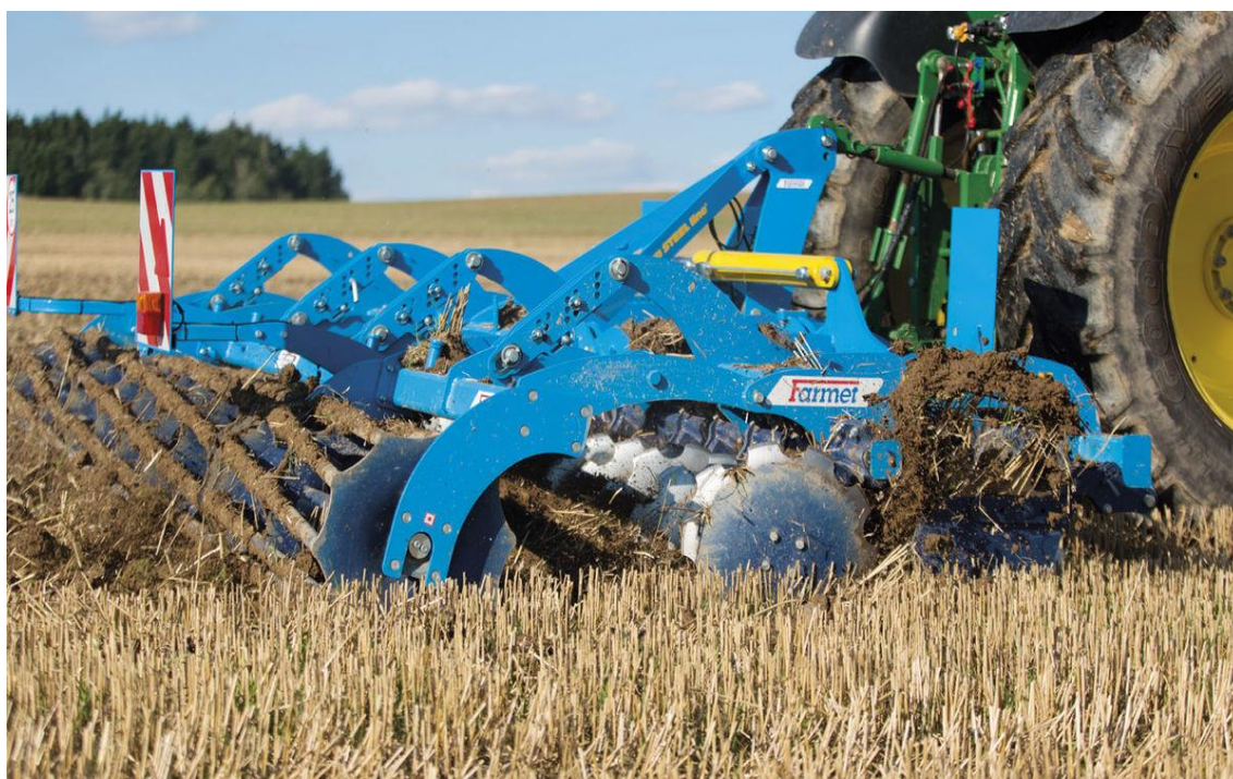
Obr. 4 - Talířový kypřič při práci na pozemku
