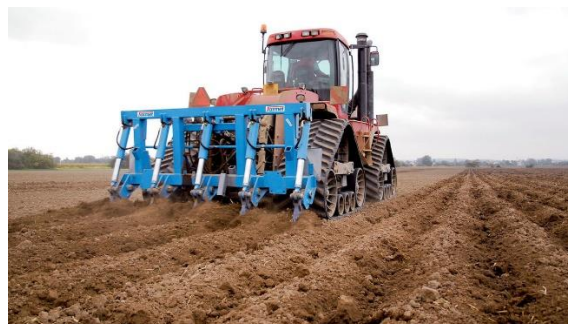
Obr. 15 - Dlátový kypřič při práci
