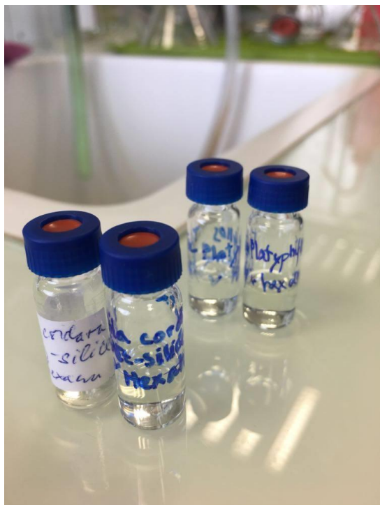
Fotografie č. 2: Vzorky připravené k analýze na plynovém chromatografu
