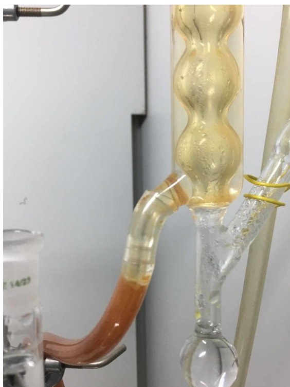
Fotografie č. 3: Silice v Clavengerově nástavci při destilaci
