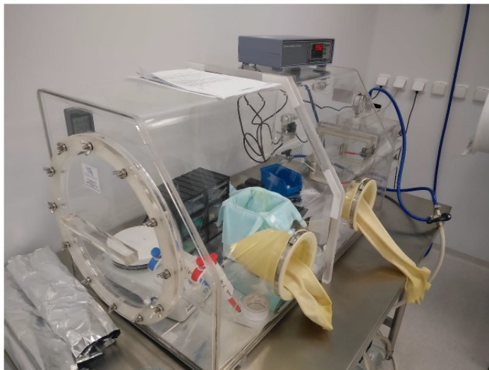
Obrázek 8. Suchý box určený pro aplikaci děrové transportní a aktivní vrstvy perovskitových fotovoltaických článků
