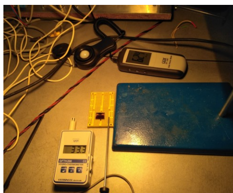
Obrázek 17 Připravené pracoviště k posouzení vlivu záření jako degradačního mechanismu. Teplota na povrchu perovskitového článku dosahovala 35 \text{ }^\circ\text{C} ; relativní vlhkosti během měření nepřekročila 35% RH; výkon xenonové výbojky 850 \text{ W/m}^2 .
