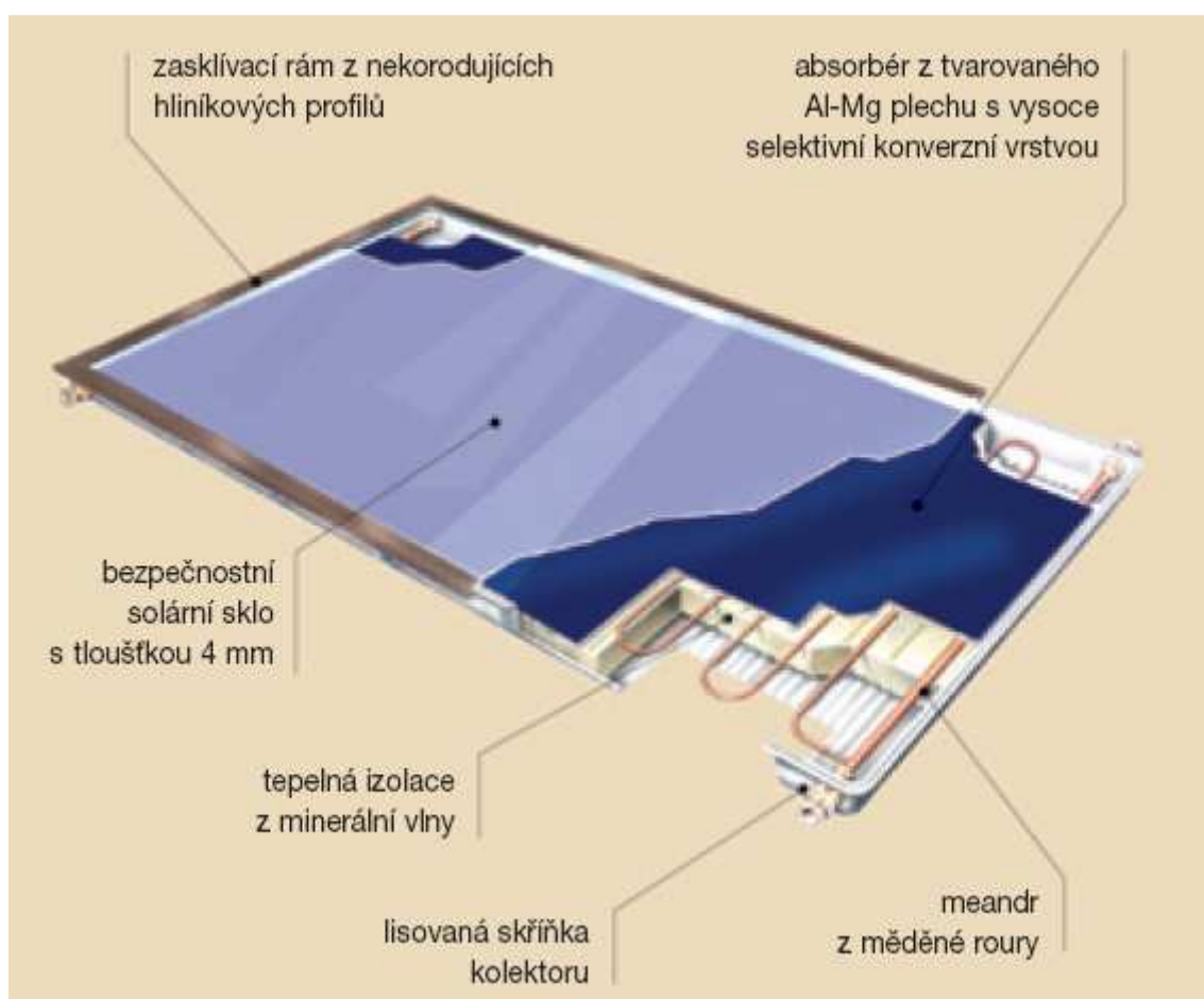
Obr. 6.5: Řez plochým selektivní kolektorem TS300
