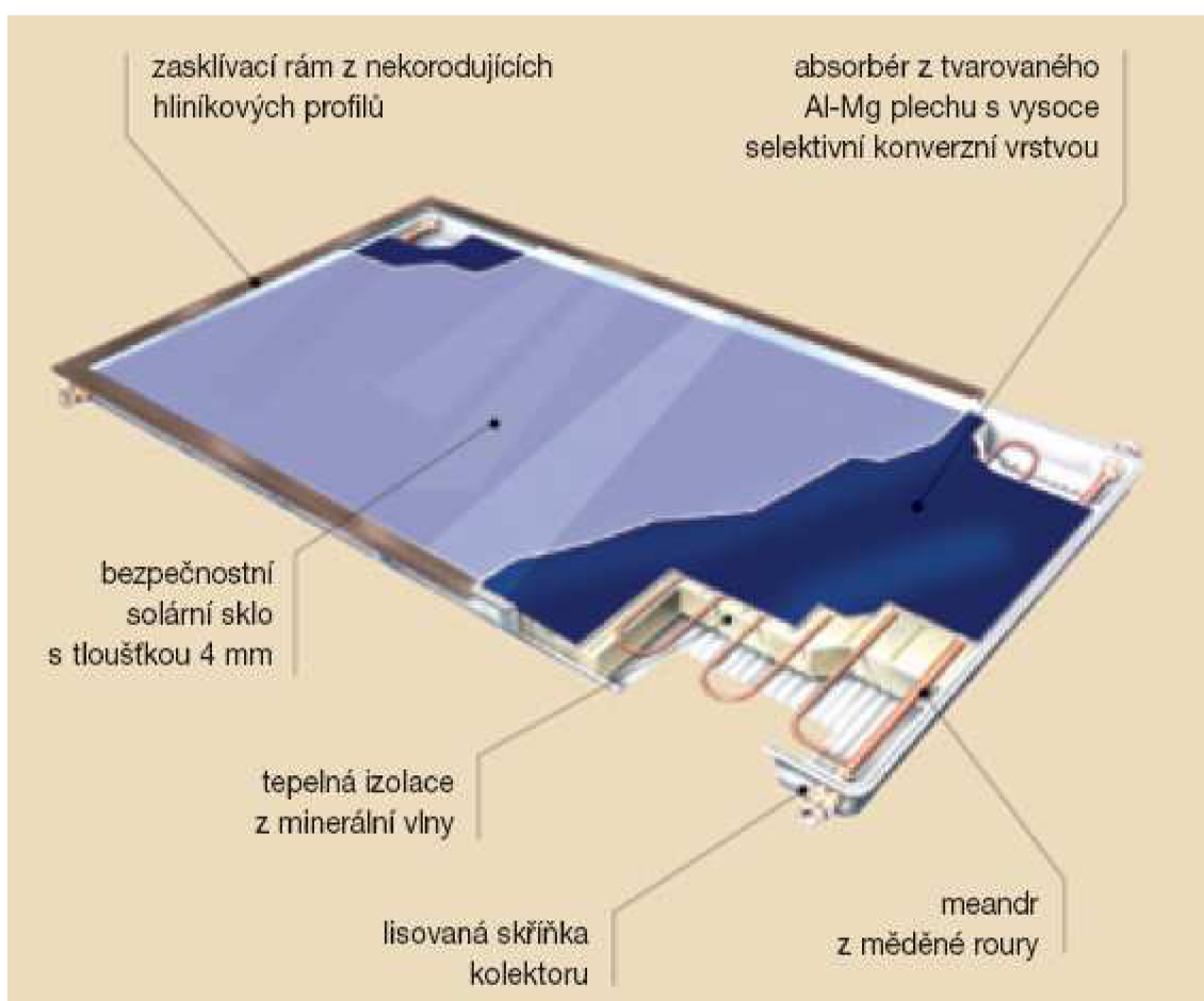
Obr. 6.5: Řez plochým selektivní kolektorem TS300
