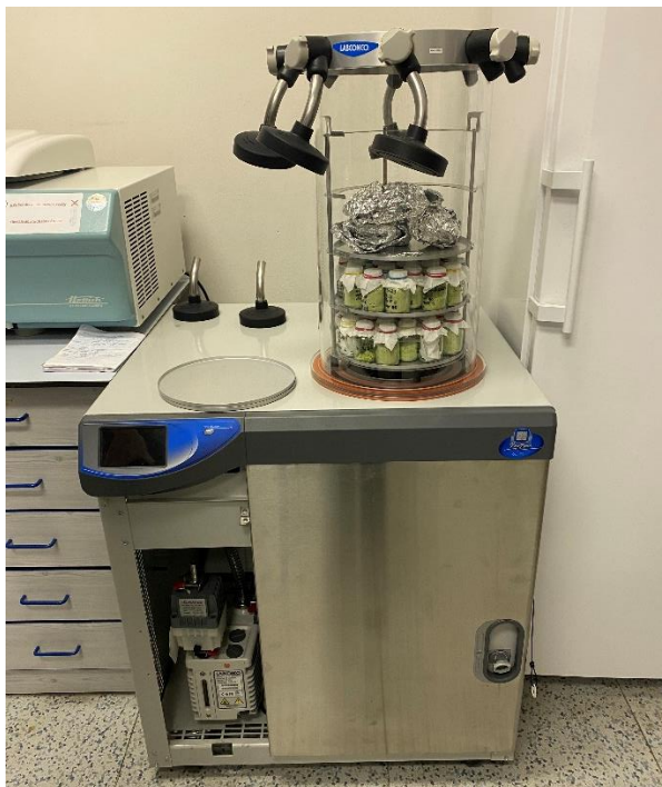
Obrázek 8: Lyofilizátor se vzorky plodů (vlastní fotodokumentace)
