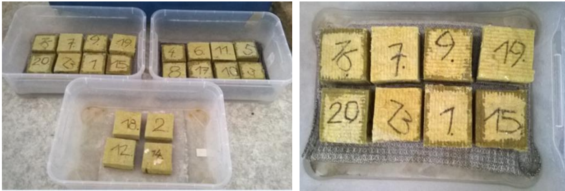
Obr. 8.2: Fotografie dokumentující uložení vzorků do boxu s vodou a nasáklou tkaninou. Vzorky byly v kontaktu s vodou jen svrchní plochou fasádní úpravy.
