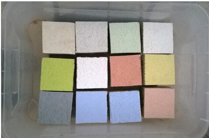
Obr. 8.1: Fotografie vzorků tvořených deskou z minerální vlny s fasádním souvrstvím upraveným na kvádry a připravených na zkoušku nasákavosti.
