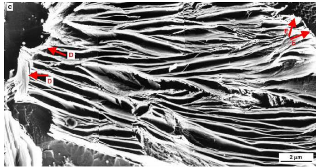
Obr. 14 SEM morfologie perlitu a proeutektoidního feritu hluboce leptané podeutektoidní oceli [9].
