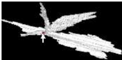
Obr. 27 [15] Trojrozměrný model skupiny AF útvarů rostoucích z vměstku
