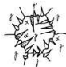
A - alotriomorfní částice na hranicích zrn; B - Widmanstattenovy desky primární; C - W desky sekundární; D - W desky intergranulární; E - pilovité částice primární; F - pilovité částice sekundární; G - idiomorfní částice intergranulární; H - idiomorfní částice na hranicích austenitu; I - masivní struktura.
