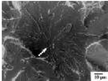
Obr. 4 [23] SEM, lomová plocha po zkoušce rázem v ohybu za pokojové teploty. MO legovaná Ti, V i Ca.
