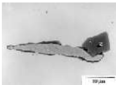
Obr. 2 [23] Vícefázový vměstek. 1. (Ti,V)(C,N), 2. Al_2O_3 , 3. MnS
