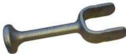
Obr. 61 Dokončený výkovek po otryskání
