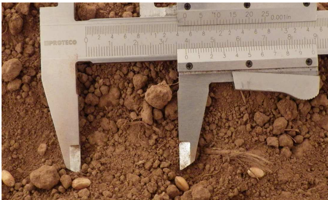
Obr. č. 13 Měření rozestupu semen pšenice
