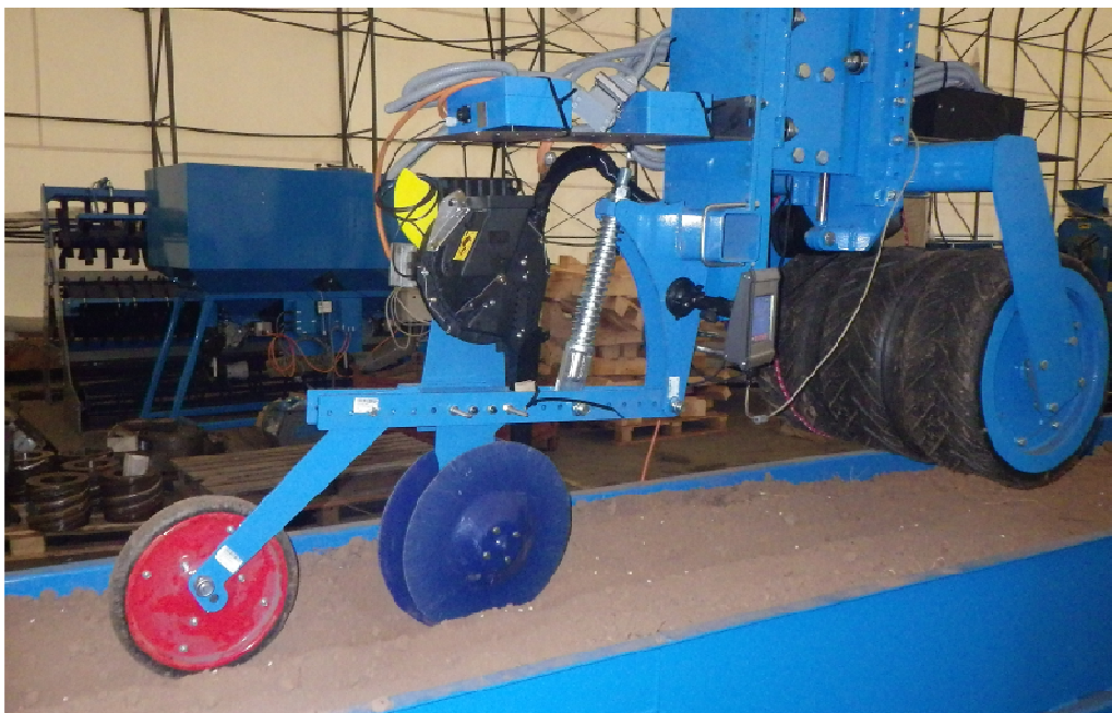
Obr. č. 8 Zkušební botka s přesným výsevním zařízením
