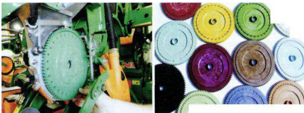
Obrázek č. 3 - Výsevní kotouče AMAZONE ED
