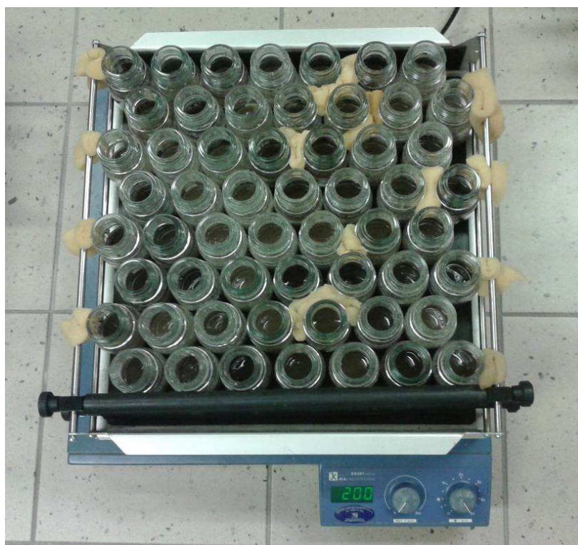
Obr. 22. Třepací zařízení s upevněnými vzorky o otáčkách 200 za minutu
