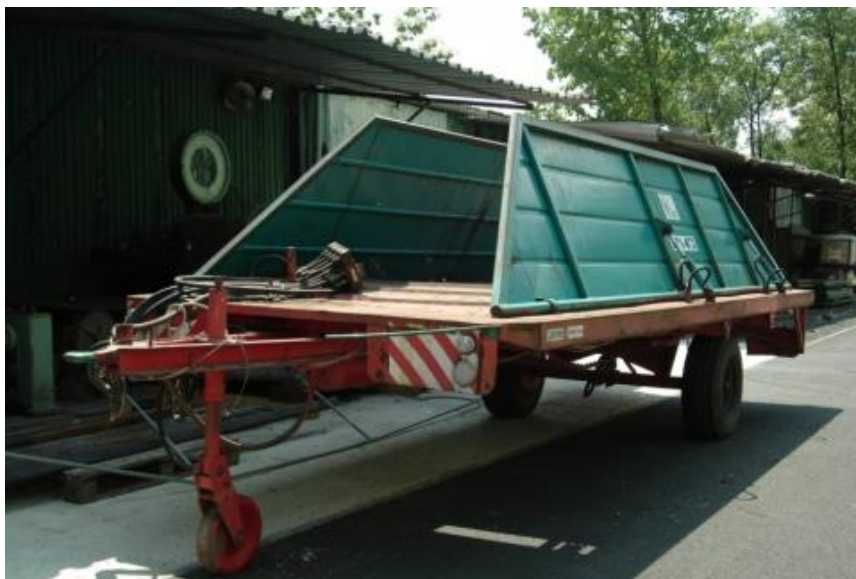
Obr. 1 Návěš pro svoz chmelové révy STS R.n.L. MV1-073 [2]
