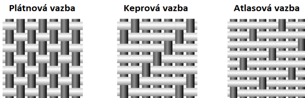
Obrázek 5: Základní 3 typy nejpoužívanějších vazeb tkanin [ http://www.xcomposites.com/woven.html ]
