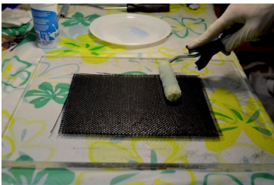
Obrázek 39: Prosycování první vrstvy tkaniny pryskyřicí
