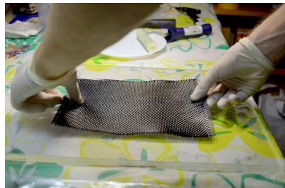
Obrázek 38: Umístění první vrstvy tkaniny
