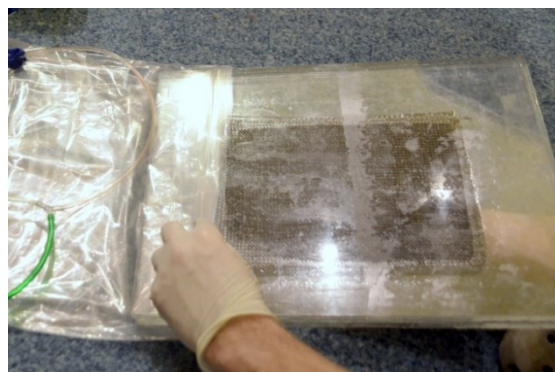
Obrázek 42: Umístění formy do uzavíratelného PE sáčku pro odsátí vzduchu
