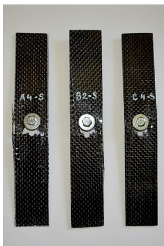
Obrázek 67: Vzhled lomů vzorků A4-S, B2-S a C4-S
