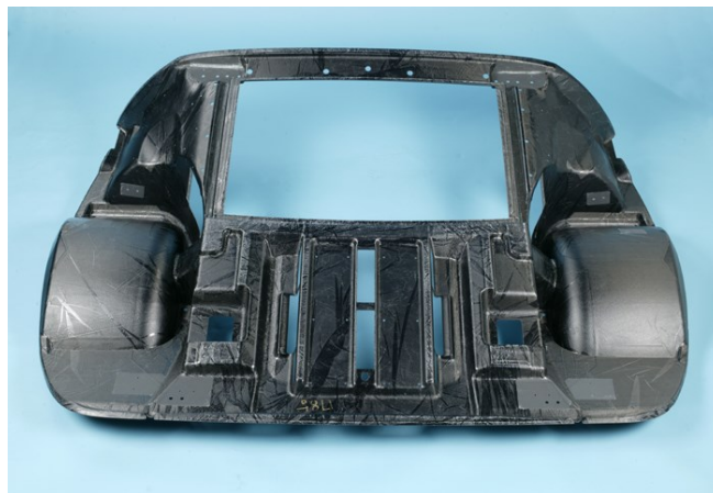
Obrázek 14: Vnitřní panel zadního krytu motoru z uhlíkového kompozitu (Ford GT 2005) [9]
