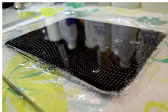
Obrázek 48: Kompozitní deska po oddělení horního dílu formy
