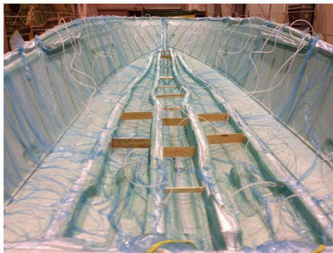
Obrázek 8: Výroba trupu lodi technologií vakuové infuze [www.compositesworld.com]
