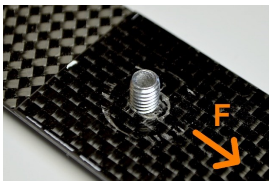
Obrázek 73: Deformovaná oblast díry vzorku C2-PS s vyznačeným směrem působení síly při tahové zkoušce
