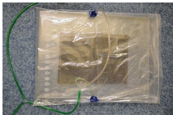
Obrázek 44: Forma vložená do sáčku
