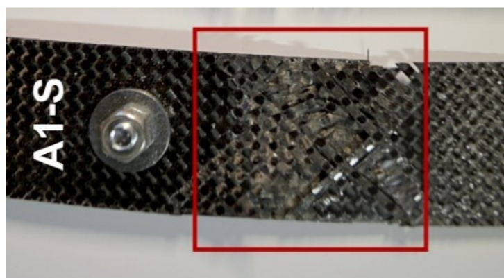
Obrázek 69: Detail vzorku A1-S s lomem mimo šroubový spoj
