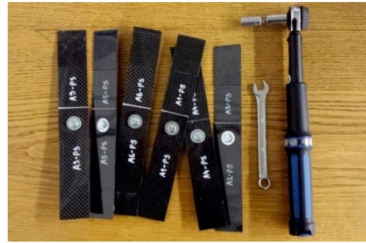
Obrázek 58: Sešroubované přeplátované spoje + momentový klíč
