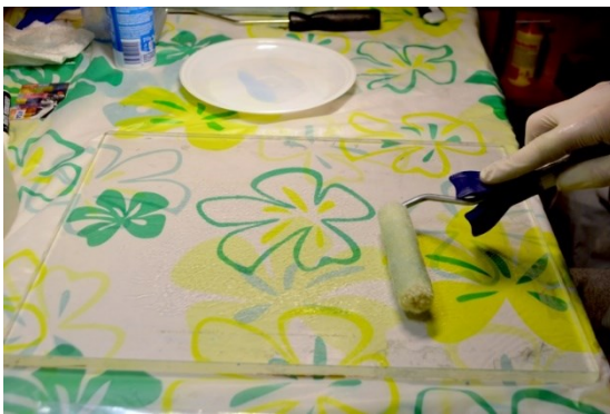
Obrázek 37: Nanášení první vrstvy pryskyřice na spodní desku formy
