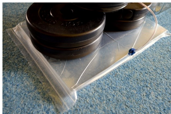
Obrázek 46: Zatížená forma po odsátí vzduchu
