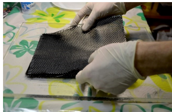
Obrázek 40: Umístění další vrstvy tkaniny
