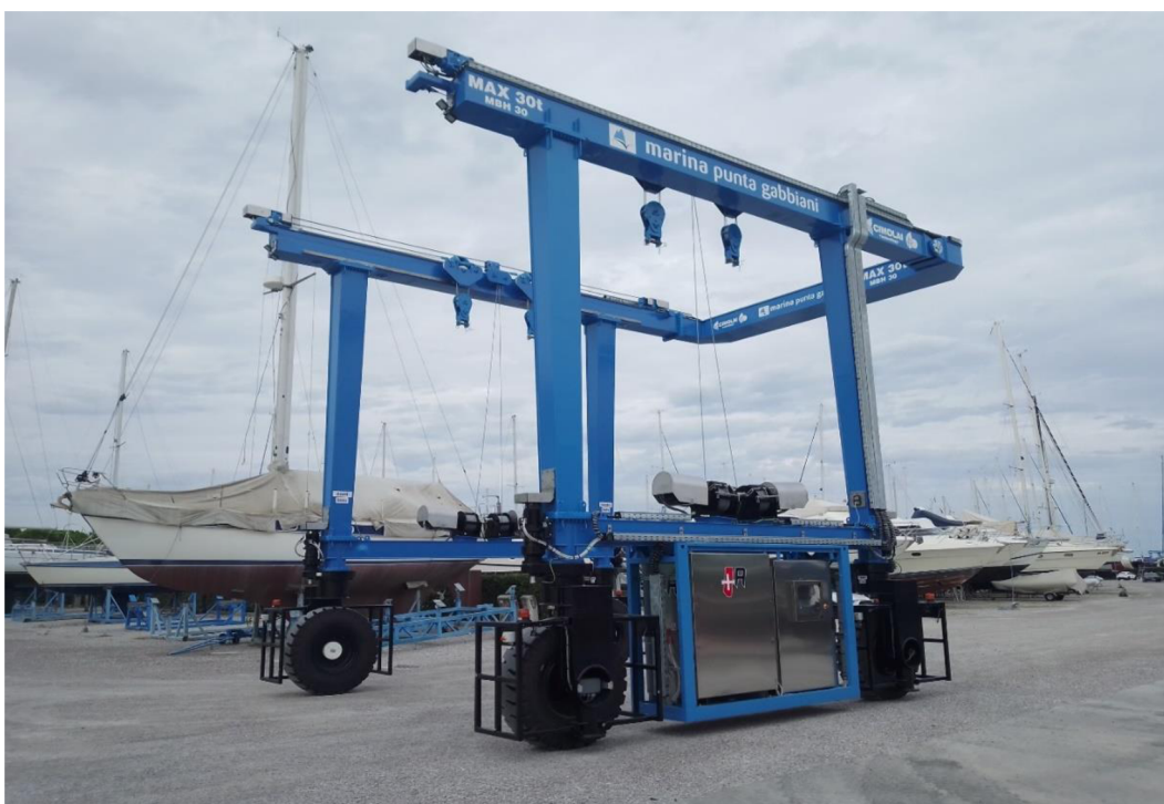
Obr. 1 Jeřáb pro manipulaci s plachetnicemi [4].
