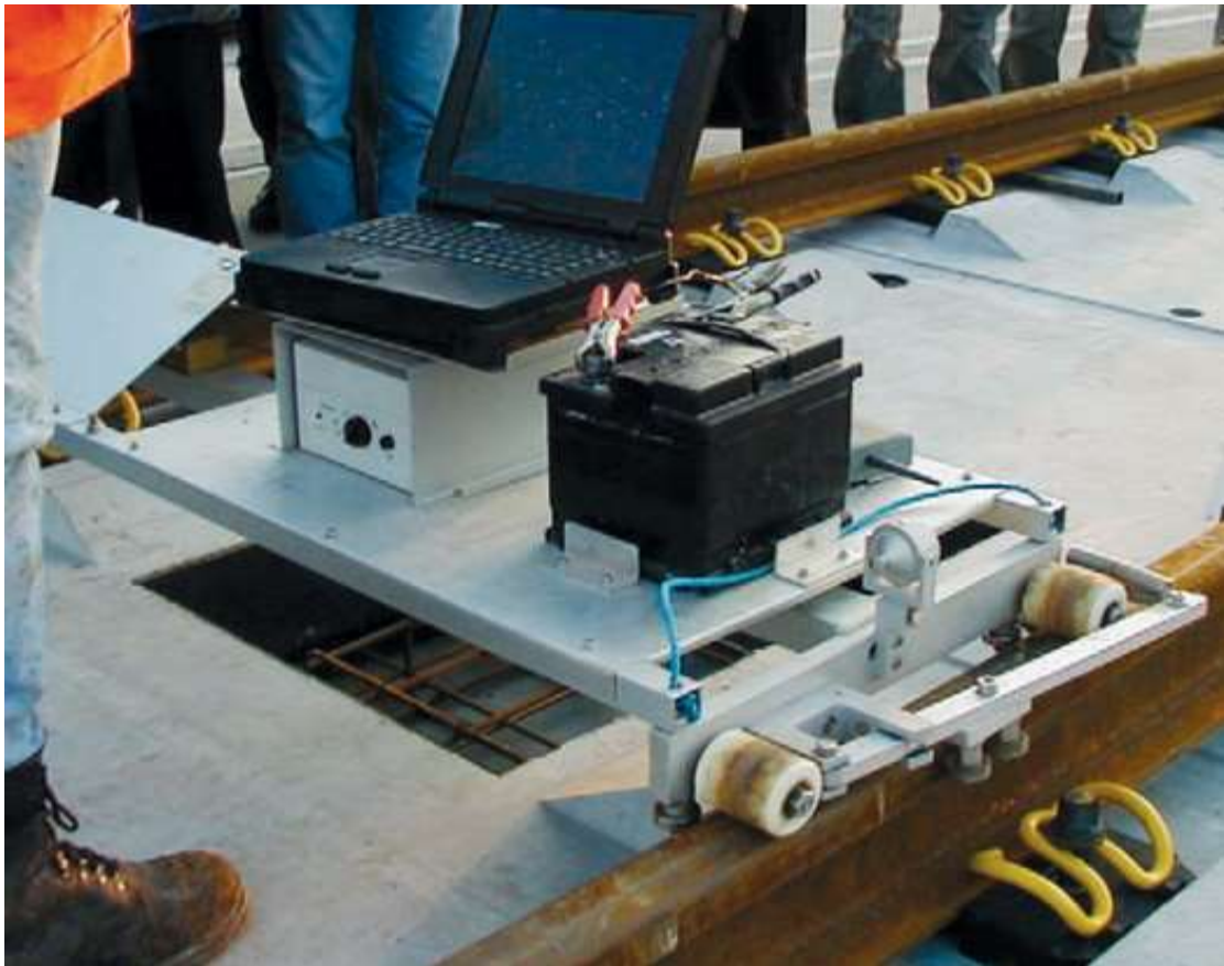
obr. č. 59: Kontrola přesné polohy koleje [24]
