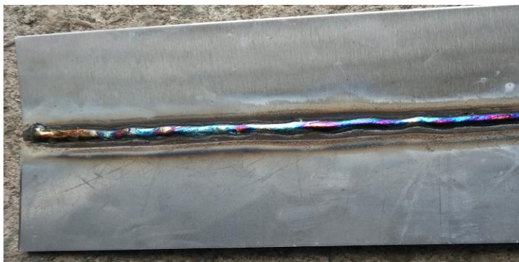
Obr. 20 Svařenec met. 111 před nadělením na potřebný rozměr
