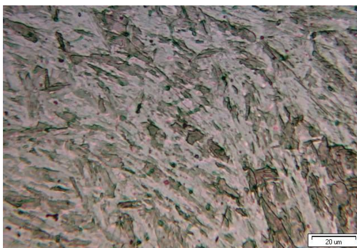
Obr. 23 Struktura přídatného mat. Kowax ER 308 LSi
