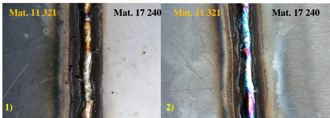
Obr. 29 1) Svarová housenka met. MMA s využitím elektrody OK 67.60 2) s využitím elektrody OK 63.85 základních materiálů 11 321 a 17 240
