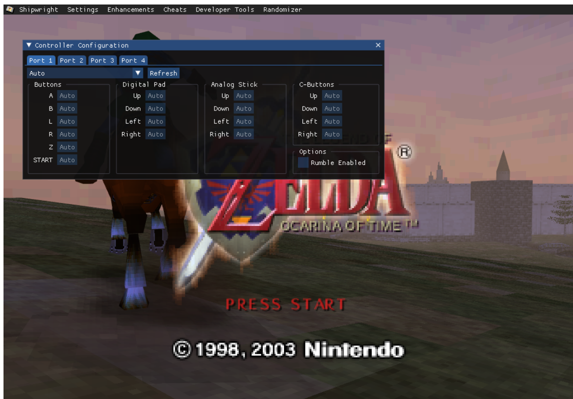
Obrázek 5.1: Dear ImGui je velmi populární knihovna a poskytuje velmi jednoduchý způsob, jak zkonstruovat GUI . V tomto obrázku můžeme vidět použití Menu lišty, plovoucího okna, záložky, tlačítka, Drop-down menu či přepínačů.
