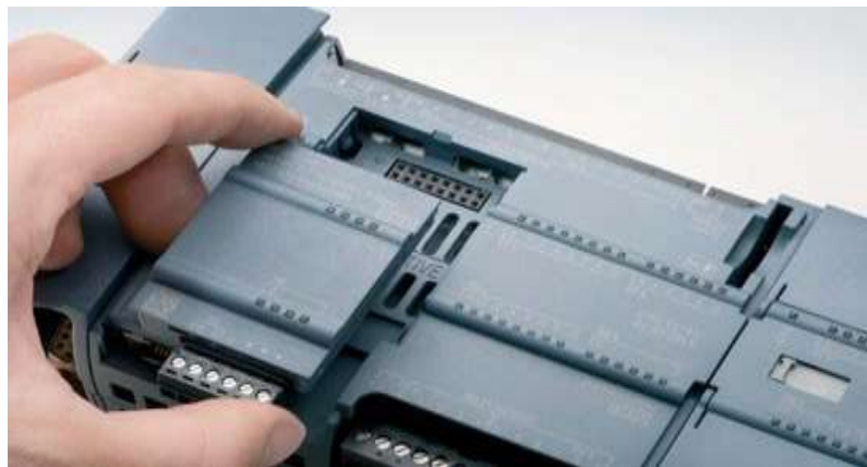
Obrázek 40 Vkládání signální desky do modulu CPU[12]
