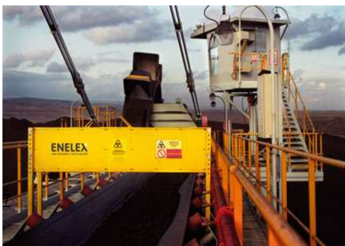
Obrázek 33 Detekční stupeň gamapopeloměru [7]
