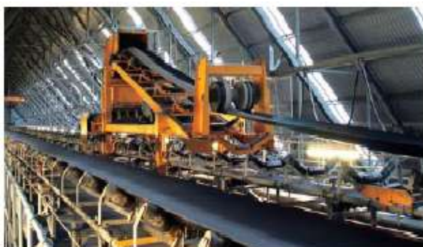
Obrázek 17 Zakládací vůz včetně pojízdných kolejnic při procesu zakládání materiálu [2]
