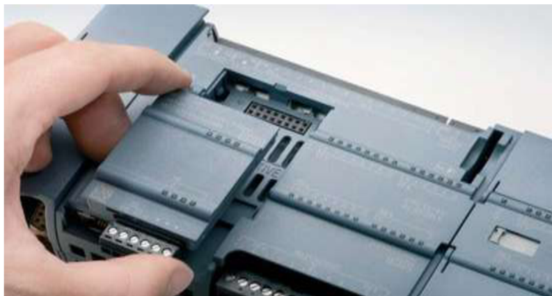
Obrázek 40 Vkládání signální desky do modulu CPU[12]
