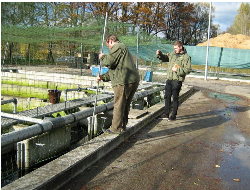
Obr. 8: Odběr vzorků ze dna odtokového kanálu (foto: L. Mareš)
