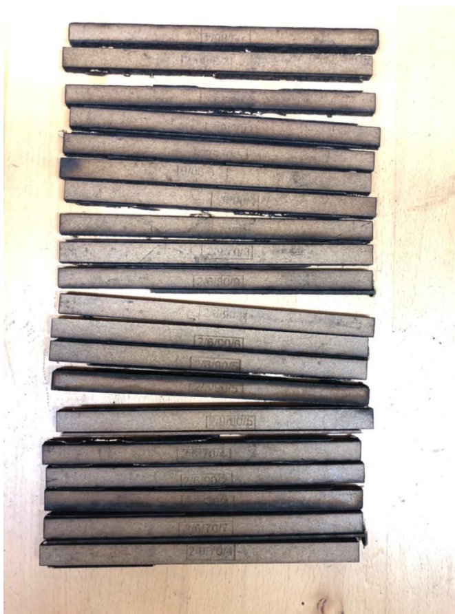
Obrázek 20 Ukázka vzorku DTD po řezání
