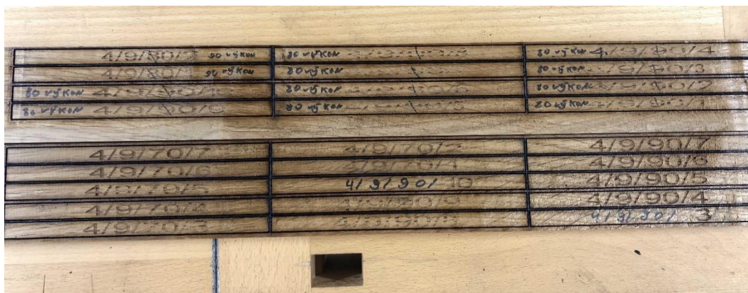
Obrázek 23 Příklad vzorků dubů, který laser neprořízl
