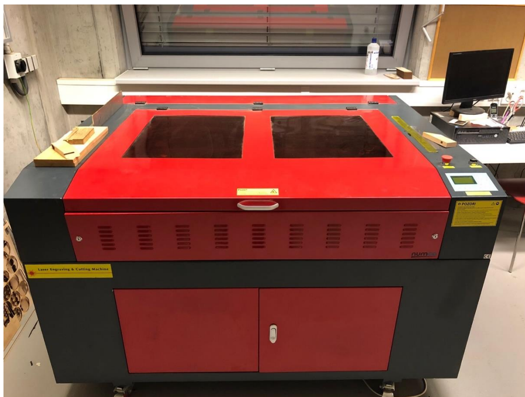
Obrázek 17 Gravírovací a řezací CO2 laser Numco C 1290
