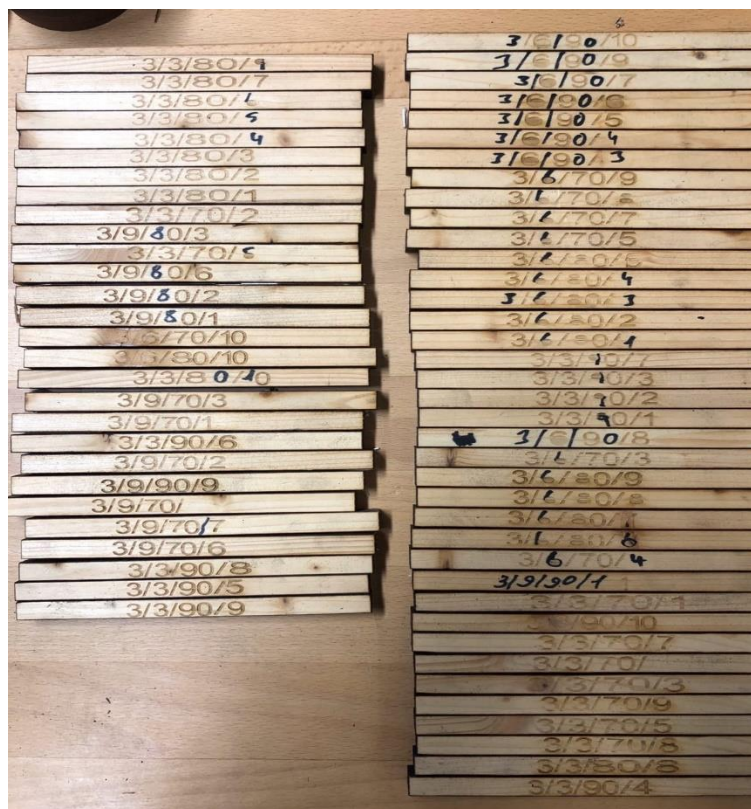
Obrázek 21 Ukázka vzorků smrků po řezání
