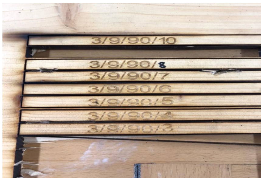
Obrázek 22 Ukázka vzorků smrků, které laser neproříznul
