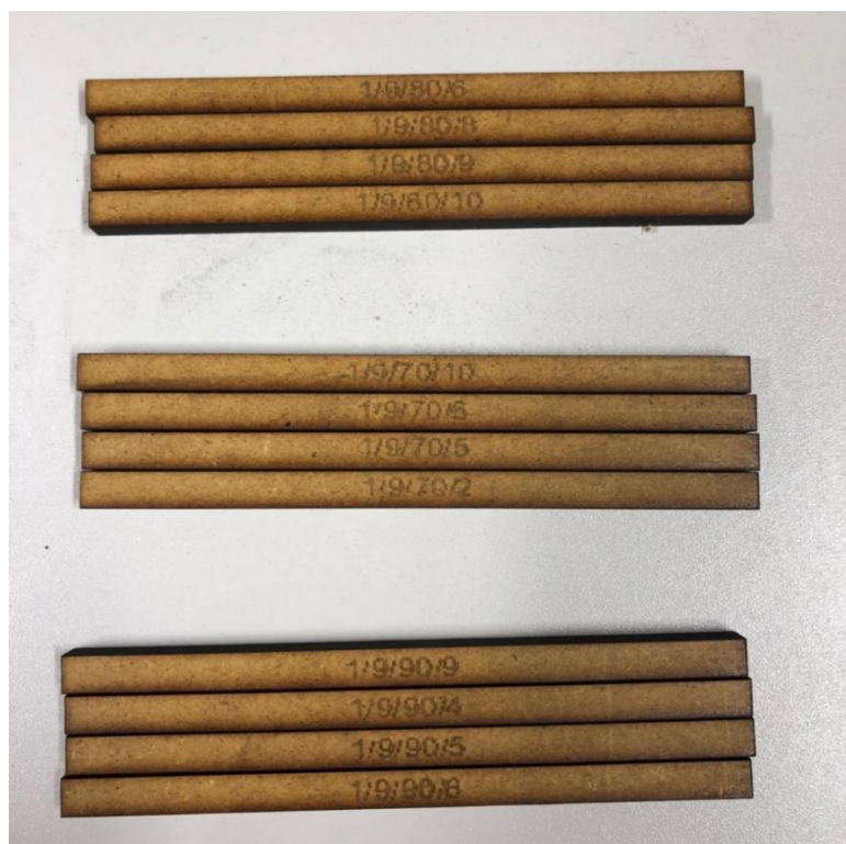
Obrázek 19 Ukázka vzorků MDF, který laser neprořízne
