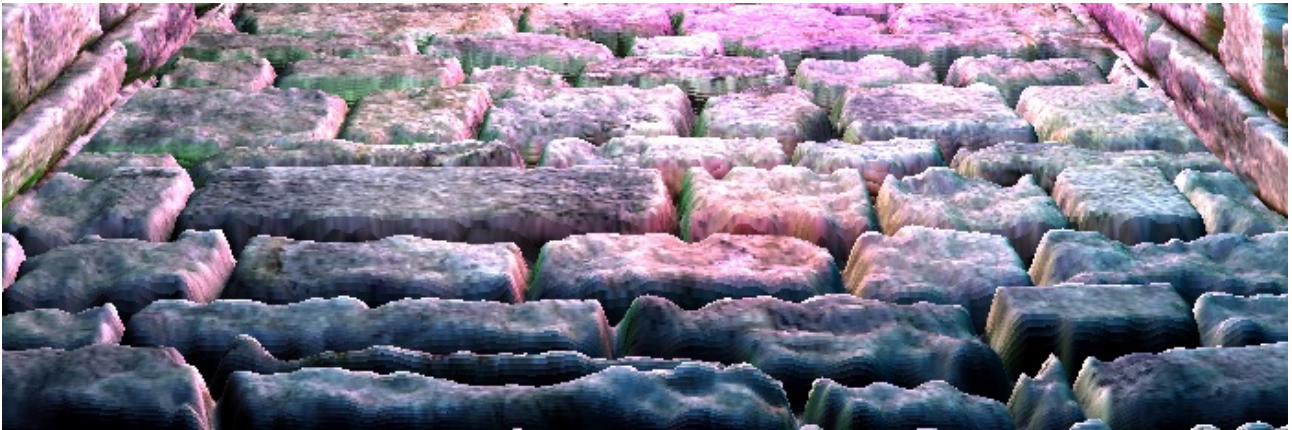
Obrázok 4.5.3: Steep parallax mapping v praxi pri použití tridsiatich krokov, na obrázku je badať jemné „vrstvy“. Obrázok pochádza priamo z mojej aplikácie.
