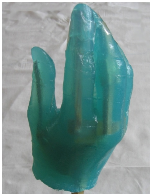
Obr. C.4 Fotografie lití agaru do formy a výsledného fantomu.
