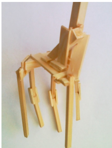
Obr. C.3 Fotografie nosné kostry fantomu vyrobené ze smrkového dřeva.
