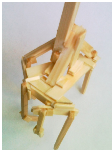
Obr. C.3 Fotografie nosné kostry fantomu vyrobené ze smrkového dřeva.
