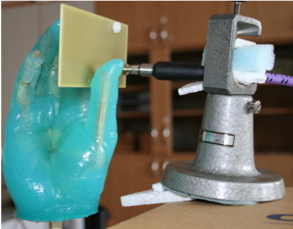
Obr. D.1 Fotografie fantomu vlastní ruky při měření impedančního přizpůsobení.
