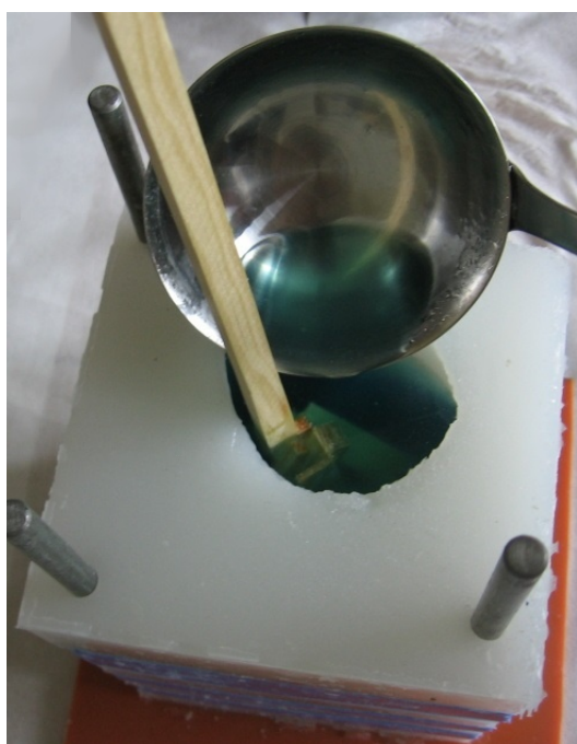
Obr. C.4 Fotografie lití agaru do formy a výsledného fantomu.
