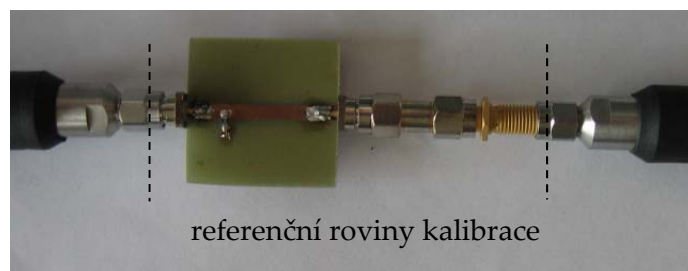
Obr. 7.7 Měření rozptylových parametrů přizpůsobovacího obvodu.
