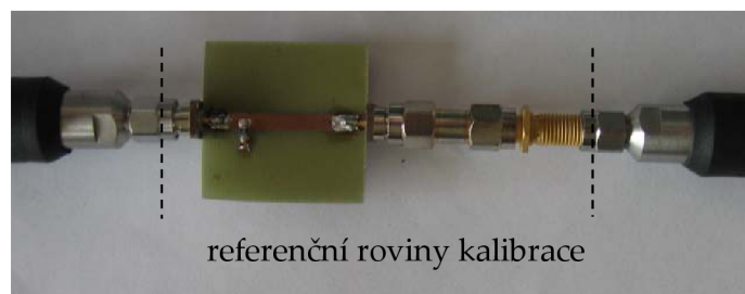
Obr. 7.7 Měření rozptylových parametrů přizpůsobovacího obvodu.
