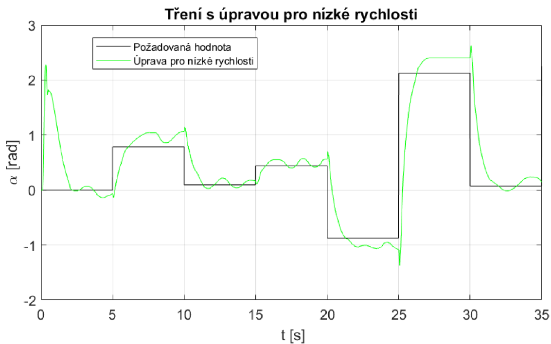
Obr. 41: Řízení s modelem tření s úpravou pro nízké rychlosti
