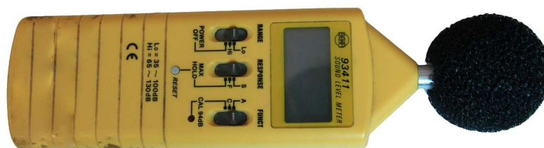
Obrázek 3.6: Hlukoměr UNITEST 93411 pro záznam hladiny akustického tlaku.
