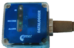
Obrázek 3.3: DATA LOGGER pro záznam teploty a relativní vlhkosti vzduchu.
