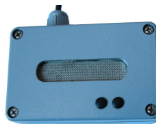
Obrázek 3.4: Čidlo pro určení koncentrace oxidu uhličitého ve vzduchu. Zdroj: Vlastní foto
