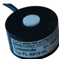
Obrázek 3.5: Čidlo pro měření intenzity osvětlení Zdroj: Vlastní foto
