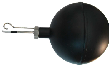
Obrázek 3.2: Vernonův kulový teploměr pro stanovení střední radiační teploty.
