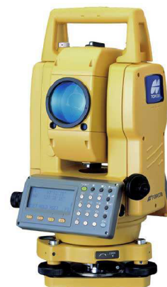
Obrázek 3-13: Použitá totální stanice Topcon GPT-3003N
