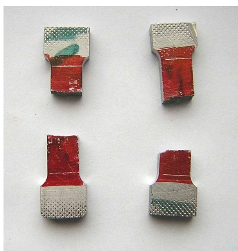
Obr. 3.3: Vzorky po zkoušce tahem
