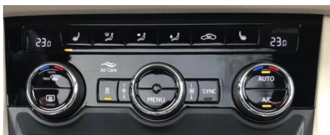
Obr. 19 - Automatické ovládání klimatizace
