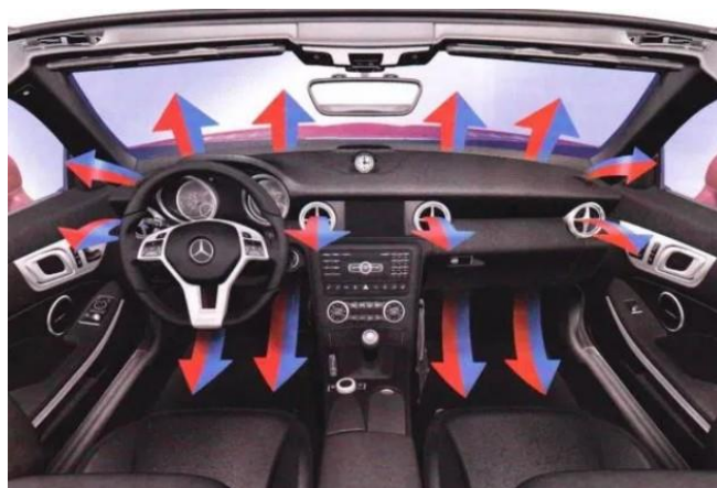
Obr. 15 - Rozvod vzduchu ve vozidle
