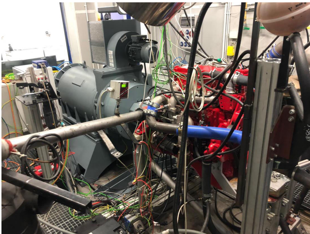
Obrázek 16. Funkční vzorek dvoupalivového motoru v laboratoři TUL 2.
