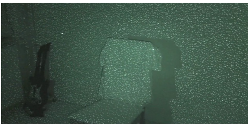
Obrázek 2.8: Paprsky z IR projektoru. Převzato z [16]
