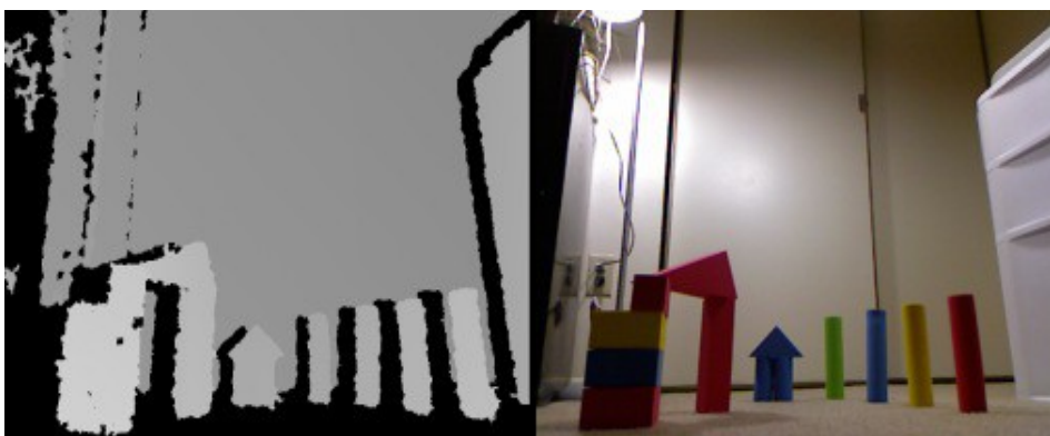
Obrázek 2.9: Vpravo obraz z RGB kamery, vlevo stejný obraz pomocí hloubkové mapy ve stupních šedi
