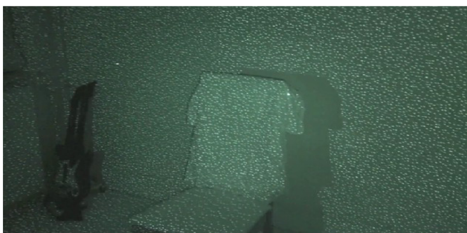
Obrázek 2.8: Paprsky z IR projektoru. Převzato z [16]
