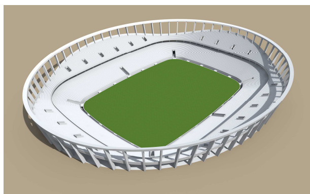
Obr. 6.11: Betonáž vnější elipsy, zavěšení vnitřní elipsy na nosná lana (1. fáze výstavby)
