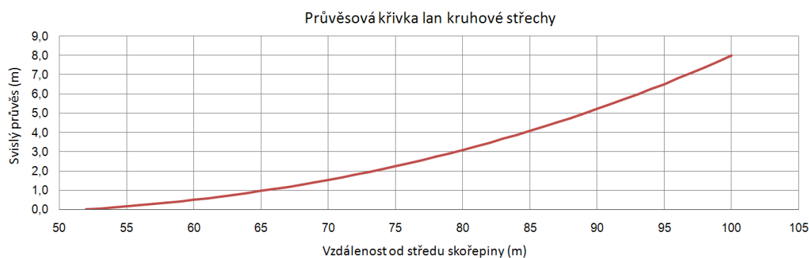
Graf 6.1: Průvšová křivka lan střechy nad kruhovým půdorysem
