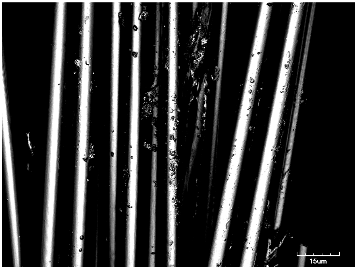
Obr. 22: Adheze matrice k výztuži (2)
