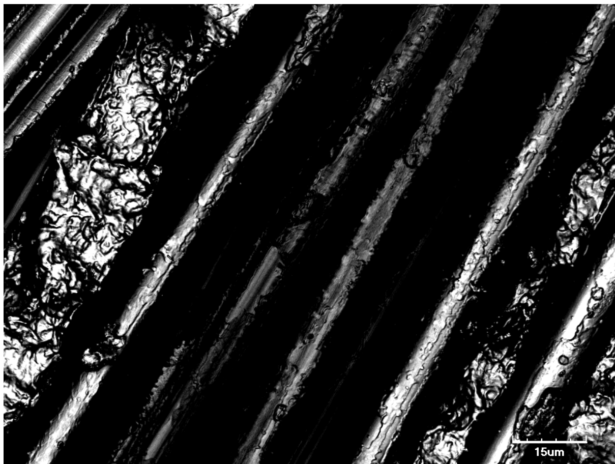
Obr. 21: Adheze matrice k výztuži
